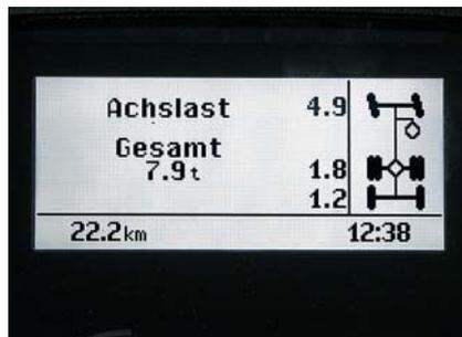
Die Achslastmesseinrichtung zeigt den aktuellen Beladungszustand der einzelnen Achsen an.
