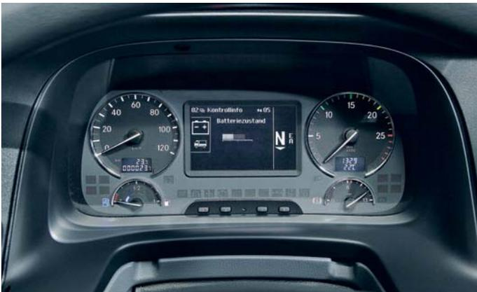
Die Informationszentrale hält Sie auf dem Laufenden, z. B. über Drehzahl, Geschwindigkeit, Tankinhalt und Bremsdruck, Service- und Diagnoseinformationen.
