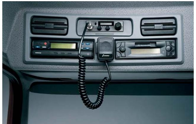
Die Funkzentrale des Axor: das kompakte Mobilgerät mit 40 Kanälen, praktischem Kanalwähler und Balkenanzeige für die Partnersignalstärke. Mit Mikrofon, Mikrofonhalterung und Montagebügel für den einfachen Einbau in die Ablage über der Windschutzscheibe.
