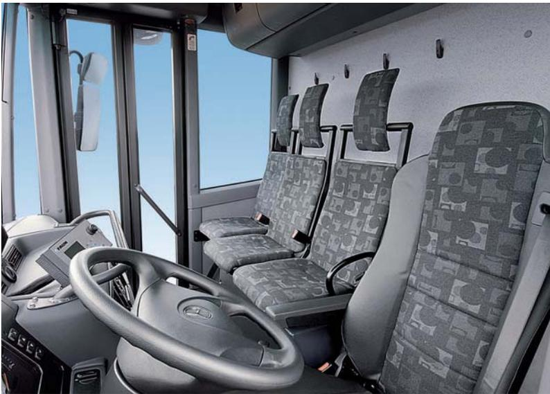
Das Fahrerhaus mit verglaster Falлтür und tiefer Sitzposition der Besatzung. Das verbessert für den Fahrer die Übersicht und erhöht die Sicherheit der Passanten.
