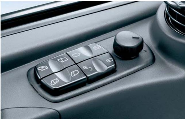
Auf Knopfdruck verstellbar sind mit dem neuen Türbedienfeld die Spiegel auf Fahrer- und Beifahrerseite, die Spiegelheizung, die elektrischen Fensterheber auf Fahrer- und Beifahrerseite sowie auf Wunsch die Zentralverriegelung oder die Komfortschließenanlage.
