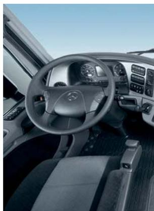
Das Multifunktionslenkrad lässt sich stufenlos verstellen: um 66 mm in der Höhe und 32° in der Neigung. Auf Wunsch ist ein Fahrer-Airbag erhältlich.
