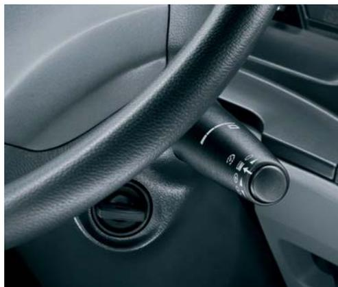
Der Antriebs- und Bremsstempomat verleiht dem Axor beim Gasgeben und Bremsen ein Pkw-ähnliches Fahrgefühl.
